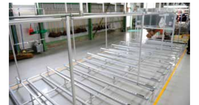
完成品を載せるシューターのコロコンには、手前側にストッパーがつけられており、一定の高さまで積み上げてから奥側へ流す仕組み。
