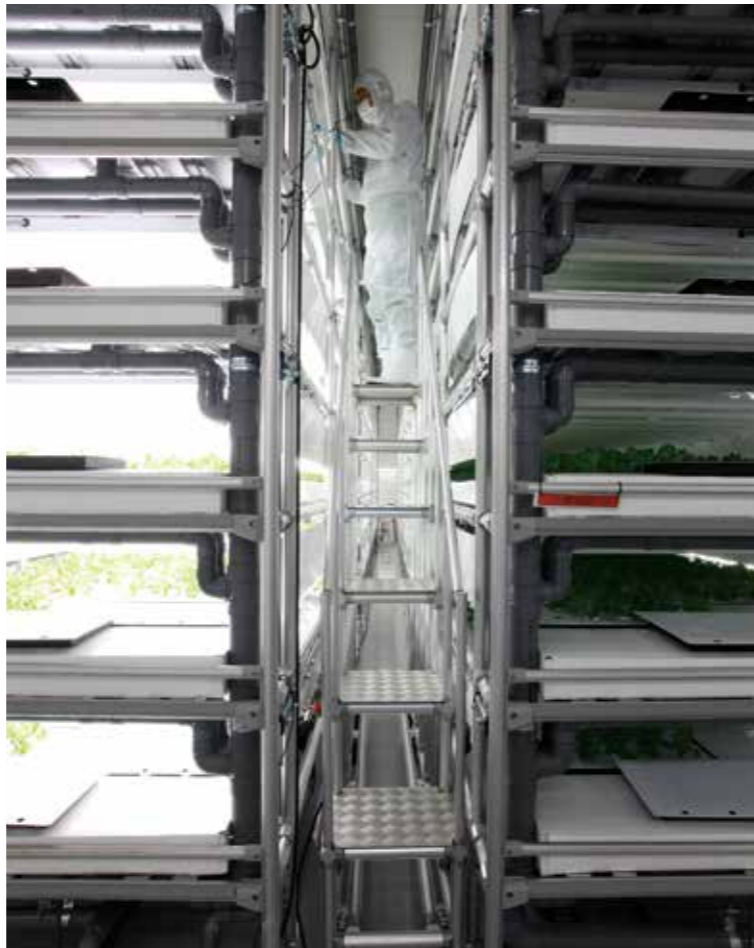
キャスターで必要な場所に移動して使用するGF製ステップ。「棚と棚の隙間に合わせた専用設計でも、標準品のように素早く安価に構築できました」(高城氏)。
