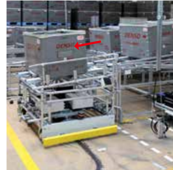
空箱の引き取り。シーソーの傾きを変え、空箱シュートから空箱を1箱だけ引き取り、生産ラインへと運搬する。
