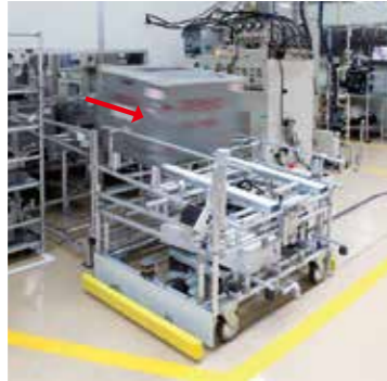
箱の移載機構部分は、若手渾身の「シーソー式からくり」。重力と台車の傾きで生産ラインから完成したエアコンを引き取る。
