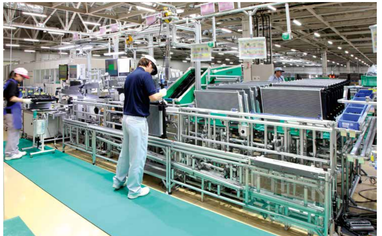
SUSのGFで組み上げられたECM組立ライン。至る所に「回す」「取り出す」「送る」などの小さな要素が盛り込まれており、作業者にやさしく、自分たちで進化させることができる組立ラインとなっている。
