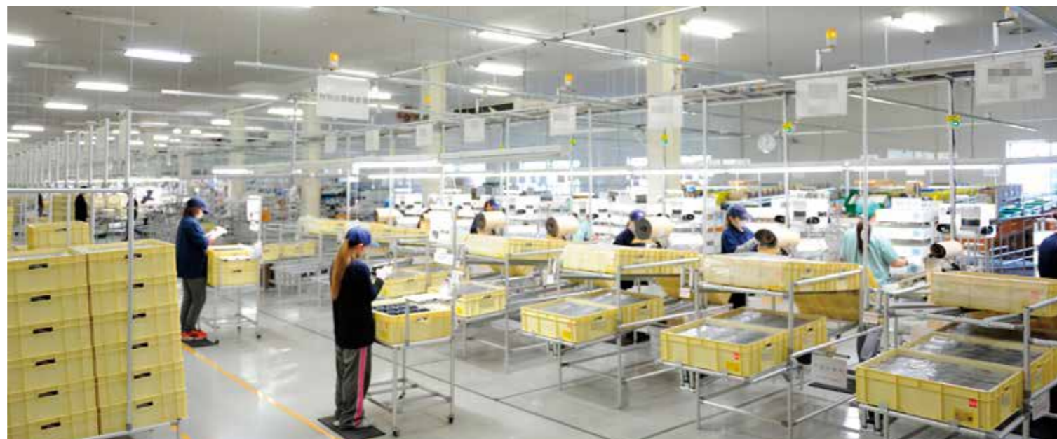
写真右奥から手前に向けてラインが流れており、段取り、組立、検査、出荷待ちへと至る。標準化されたGF製の作業台やシューターがずらりと並んでいる。
