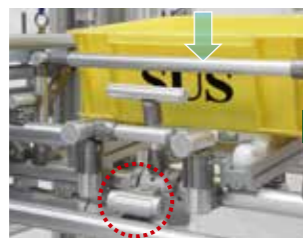
下降したウエイトがコネクタベースに当たり、その反動でピンコネクタが回ります。
