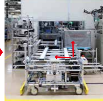
空箱供給。生産ラインへ空箱を供給した後、シーソーの傾きを変え、次の製品を受け取る準備を行う。
