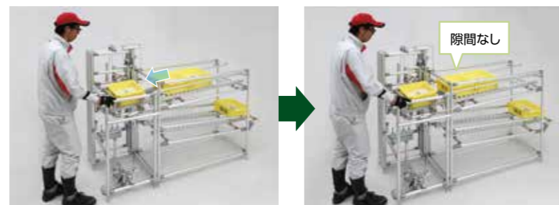
流れ込んだコンテナがテーブル内のトリガーを作動させ、再度切り出しを作動させます。
