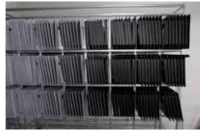
栽培パネルを乾燥させるための台車もGF製。こちらも作業台など同様、移動できるようにキャスターがつけられている。
