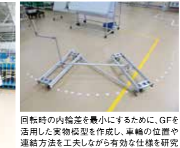
回転時の内輪差を最小にするために、GFを活用した実物模型を作成し、車輪の位置や連結方法を工夫しながら有効な仕様を研究している。
