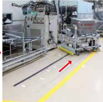
引き取ったエアコンを出荷場へ運搬。他の運搬車が通行する場合は、それを感知し一時停止して通過を待つ仕組み。
