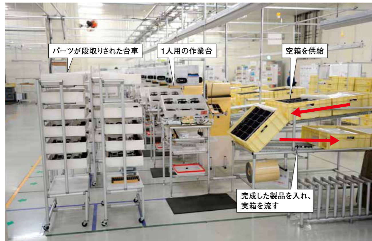
GF製の標準設備。電気を極力使用せず、治工具は社内で製作し、コストをかけずにシンプルに構築している。
