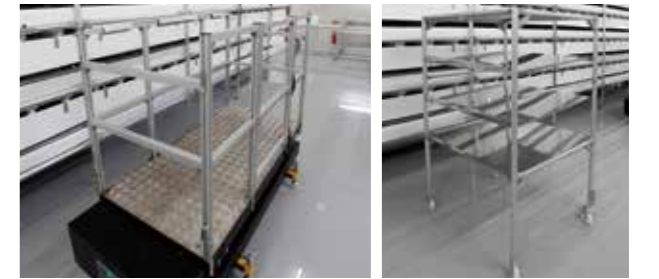
装置メーカーから購入した高所作業台車の手すりはアルミ構造材SFで構成されており、GF製の台車と合わせて使用できるよう設計されている。
