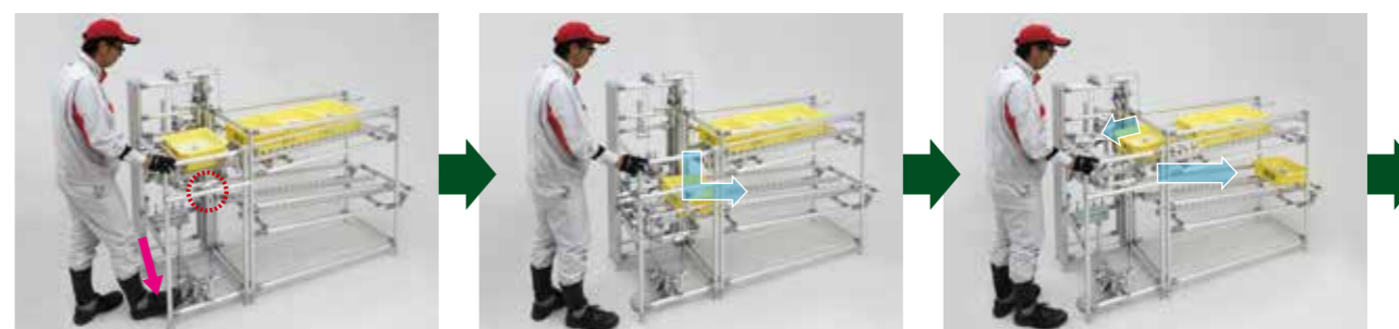
フットペダルを踏むと昇降動作ロックがはずれ、ワークの重みでテーブルが下降します。
