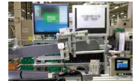
生産中の製品と同期して「かんばん」が流れてくるので、「かんばん」に印刷されているQRコードを自動読み取りする。
