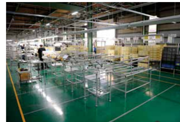
ラインの組み換え・増設に向け、準備中の作業台とシューター。古いラインで使用していたフレームもリユースしている。
