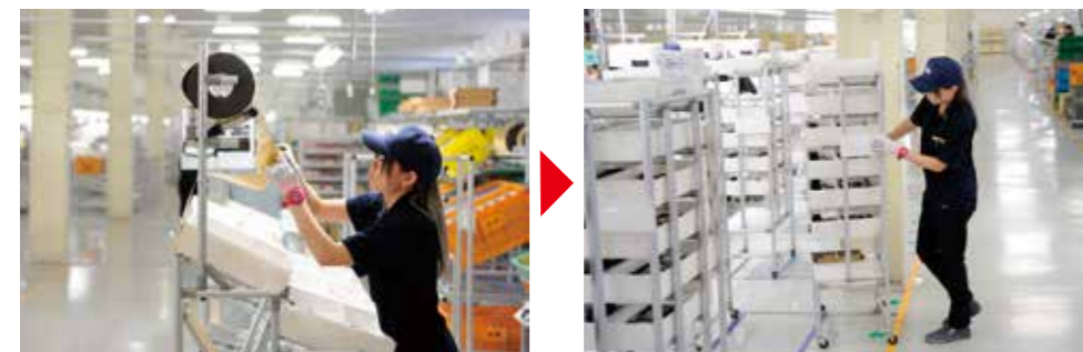
GF製の標準設備。電気を極力使用せず、治工具は社内で製作し、コストをかけずにシンプルに構築している。
