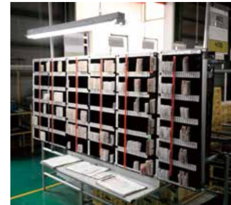
平準化生産ポストでは、30分単位で細かく「かんばん」が仕分けされている。
