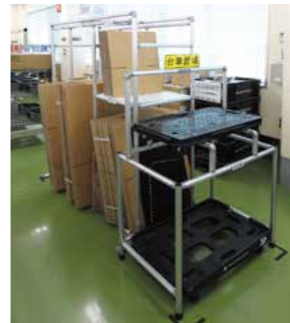
静電気対策のために採用した導電性の平台車。フレームを挿すための穴加工を施しており、運搬時のみGF製の取っ手を差し込む仕様で、保管の際は重ねての収納が可能。
