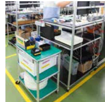
作業台は使いながら改良を重ねている。以前は小物用の台車を別に用意していたが、本当に必要な道具にしばり、作業台に小型のテーブルを追加する形に変更した。
