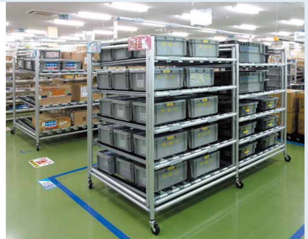
GFで新たに製作した在庫保管用の棚。棚の高さを部品に合わせて1段ずつ細かく調整し、スペースの無駄を削減している。
