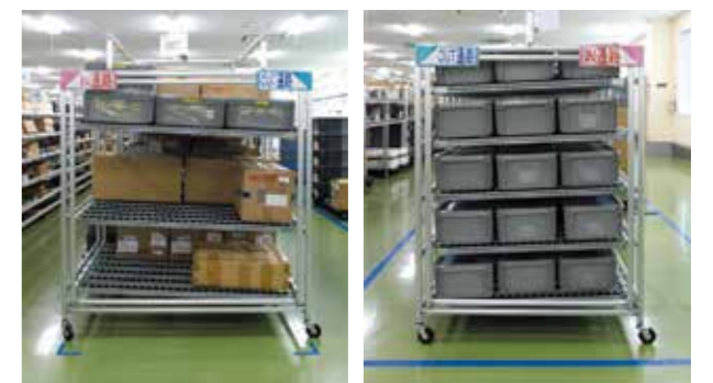
棚は大きく分けて奥行き120cmと70cmの2タイプ。以前は120cmが主流だったが、置き換え時には部品の小型化に合わせて70cmのものを増やしている。
