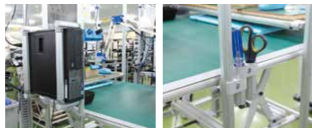
標準の作業台を元にパソコンや必要な工具を収納できる仕様にカスタマイズしている。
