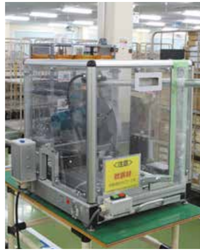
物流センターで使用している電動カッター。レバーの出口部分にビニールのカバーを取り付け、切り粉の飛散を抑えている。
