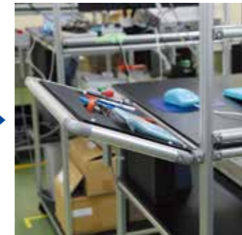
作業台は使いながら改良を重ねている。以前は小物用の台車を別に用意していたが、本当に必要な道具にしばり、作業台に小型のテーブルを追加する形に変更した。
