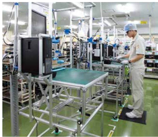
ボードリフターキットを使用し、台の高さを調節可能にした前加工工程の作業台。足元にはキャスターをつけ、レイアウトの変更にも柔軟に対応する。
