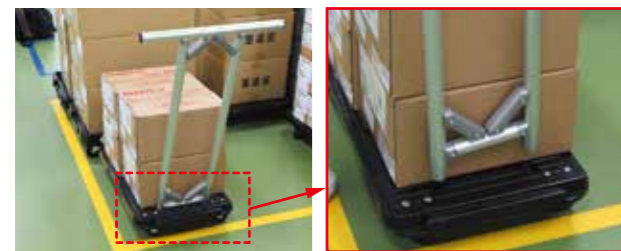
静電気対策のために採用した導電性の平台車。フレームを挿すための穴加工を施しており、運搬時のみGF製の取っ手を差し込む仕様で、保管の際は重ねての収納が可能。
