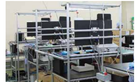
GF製に一新された検査工程の作業台。台の上にディスプレイを置かず直接取り付けることで、スペースを確保している。
